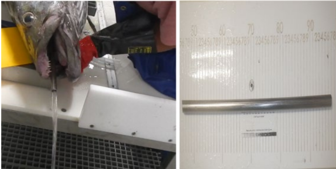
Figura 13: tubo de acero para drenar el agua del estómago de un pez antes de su pesado. Foto: Andy Smith (CAPFISH).
